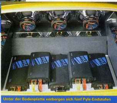
Unter der Bodenplatte verborgen sich fünf Pyle-Endstufen
