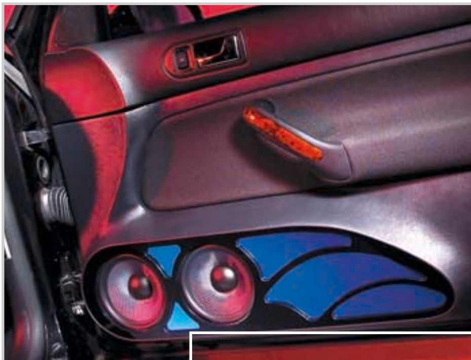
Knockin' on Heaven's Door: Gigantische Doorboards aus MDF beherbergen die pegelfesten Rockford-Woofer.
