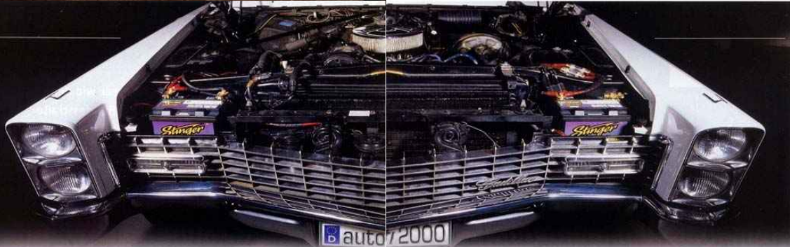
Schnauze: Unter der Motorhaube von der Größe einer Tischtennisplatte lauern ein sleben Liter großer V8 und zwei Stinger-Batterien.
