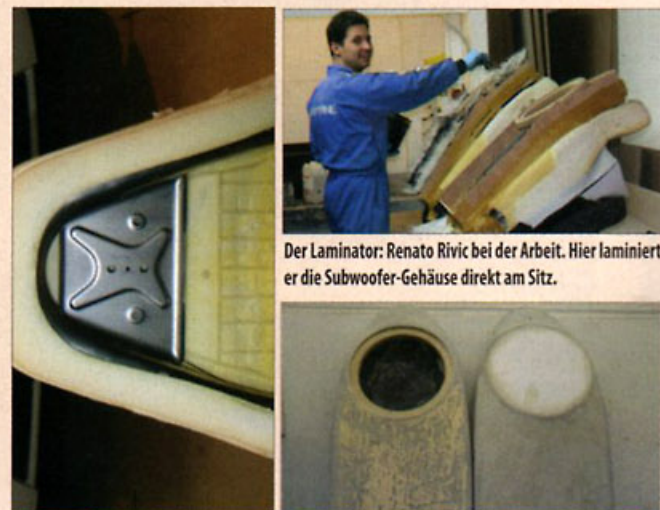
Leer: Der Sitz bietet im Originalzustand jede Menge ungenutzte Hohlräume. Fertig: Wenn die Oberfläche verspachtelt und geschliffen ist, können die Gehäuse mit Leder bezogen werden.
